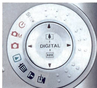
Alle wichtigen Einstellungen erfolgen über das zentrale Funktionswahl-Rad und den Navigationsknopf der Menüführung.
