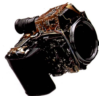
Die Elektronik sowie die wichtigsten mechanischen Teile sind um das Aluminium-Druckgussgehäuse herum angeordnet und werden von einer glasfaserverstärkten Polycarbonathülle geschützt.
