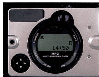
Neu und originell: Die Multifunktionskarte dient an der Kamerarückseite als Steuerzentrale.
