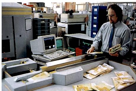
Fehler sind praktisch ausgeschlossen: Automatisches Einlesen der Filmstaschen und Sortieren nach Filmart und gewünschter Bildgrösse.
