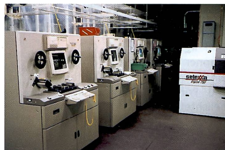
Die entwickelten Negative werden mit einem Scanner erfasst, um die Korrekturdaten zu berechnen und Indexprints herzustellen.
