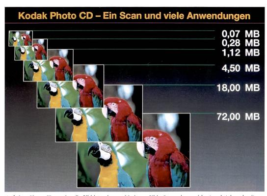
Auf einer Photo-CD werden die Bilddaten in verschiedenen Bildgrössen abgespeichert und stehen damit jeder möglichen Verwendung in ausreichender Datenqualität zur Verfügung.
