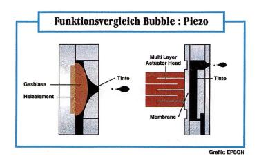
Schematischer Vergleich zwischen Bubble-Jet- und Piezo-Technologie
