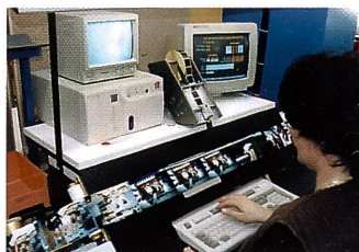
Der Korrekturtisch. Eine Videokamera liest die Bildrückseite
