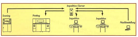
Sämtliche Verarbeitungsgeräte der APS-Linie bei Pro Ciné sind über Ethernet miteinander vernetzt. Über dieses Netzwerk können über ein im Hause entwickeltes Korrektursystem feinste Korrekturen in Farbe und Dichte sowohl bei Frischfilmen als auch bei Nachbestellungen online realisiert werden.
