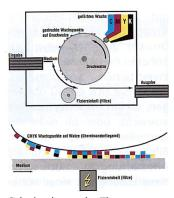
Prinzipschema des Thermowachsdruck.
