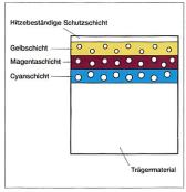
Querschnitt durch das Thermo-Autochrom-Papier von Fuji
