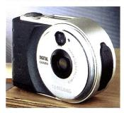
griert ist ein 4-MB-Flash-Speicher. In der VGA-Auflösung (Standard-Modus) können 48 Bilder und in der QVGA-Auflösung (Economy-Modus) 192 Bilder aufgezeichnet werden. Die Kompression erfolgt in JPEG. Die Verschlusszeit beträgt 1/4 bis 1/8000 Sekunde. Blendeneinstellung und Weissabgleich erfolgen automatisch. Die Kamera lässt sich mit einem RS-232C-Kabel an jeden PC bzw. Notebook anschliessen. Auf einer CD werden Twain-Treiber und
