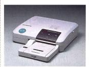
Drucktechnik der Thermosublimation, die im Gegensatz zum Tintenstrahldruck-Verfahren die Farbe nicht punktweise aufträgt, sondern nacheinander verschiedenfarbige Partikel von einer Trägerfolie ablöst, und diese quasi miteinander bei hoher Temperatur verschmolzen werden. Dadurch sind keine einzelnen Rasterpunkte mehr erkennbar.
