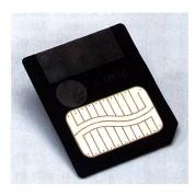
Vor dem Gebrauch muss die 2-, 4- bzw. 8-MB-Speicherkarte mit der Digitalkamera initialisiert werden. Die Aufzeichnung erfolgt elektrisch; es können bestehende Bilddaten gelöscht und neue aufgezeichnet werden. Mindestens 250.000 mal lassen sich Daten auf diesem Halbleiterspeicher aufzeichnen. Das Datenformat ist MS-DOS, das Interface ist ATA-kompatibel. Für die Datenübertragung in einen
