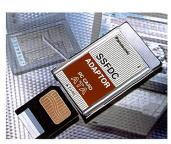
Computer wird ein PC-Card-Adapter benötigt. Zu beachten ist, dass es den Adapter in einer 5-Volt-Version sowie als Dual-Voltage-Version mit 5 oder 3,5 Volt gibt (Panasonic BN-FDAA). Die SSFDC finden Sie in der Apple QuickTake 200, Fujix DX-5 und DS-7, Minolta Dimâge V, Olympus Camedia C-820L, Sanyo D-Cam X und Toshiba PDR-2A.
