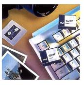
Kapazitäten bis zu 64 MB. Nachteilig ist bei dieser Karte, dass keine DOS-File-Struktur und ATA-Kompatibilität besteht, als File-Struktur wird das Flash File System eingesetzt. Auch für diese Karte wird ein spezieller PC-Adapter benötigt. Miniature-Cards erfordern für PCs spezielle Treiber. Cherry hat eine PC-Tastatur für den schnellen Universal Serial Bus (USB) mit integriertem Miniature-Card-Slot entwickelt, so dass auf
