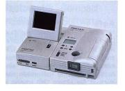
hochwertiges Retrofokus-Objektiv mit einer Brennweite von 5.2 mm (entsprechend 50 mm im Kleinbildformat), das in Makrostellung Nahaufnahmen bis 2 cm Aufnahmedistanz zulässt. Für die Aufnahmen, das Editieren der Bilder und die Datenübertragung werden
