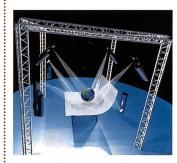
Hier das Prinzip dieses neuartigen Lichtsystems: Kier nahm sechs Spezialscheinwerfer der Firma Martin Professional A/S, wie sie in Theatern und bei grossen Live-Konzerten verwendet werden. Diese enthalten je eine spezielle MSR-Lampe mit 1200 Watt Leistung, sind in ihrer Lichtleistung, Farbe und Lichtkegel stufenlos variierbar und lassen sich aus einem einfachen PC steuern. Zudem können verschiedenste Farb- und Effektfilter in
