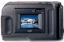
gerichtet ist. Sie liefert Bilder in 24 bit-Qualität mit 640 x 480 Pixel Auflösung und erschliesst den Motivraum mit drei Brennweiteinstellungen von neun cm bis unendlich. Zudem ist sie mit einem 4,5 cm-LCD-Farbdisplay, einer speziellen, briefmarkengrossen QuickTake-Speicherplatte mit 2 MB (oder höher) für 30 Aufnahmen in Standard- und 20 Bilder in Höchstqualität
