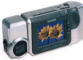
fügt über ein LCD-Display, welches als Sucher dient. Dieser ist mit 2,5" gross und erlaubt auch, die aufgezeichneten Bilder durchzusehen. Der CCD-Bildsensor hat eine Auflösung von 640x490 Pixeln. Der Bildspeicher ermöglicht die Aufzeichnung von bis zu 192 Bildern im Normalmodus respektiv 64 Bildern bei hoher Auflösung.
