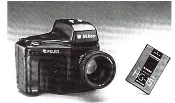
Bei der Spiegelreflex-Digitalkamera Fujiflex DS-505 / DS-515 sorgt ein Kondensor-Element dafür, dass das gesamte Sucherfeld auf dem CCD-Chip abgebildet wird. Bereits vorhandene Objektive können dadurch wie bisher eingesetzt werden. Die schnell auswechselbaren PC-Cards bieten bei einer Speicherkapazität von 15 MB Platz für bis zu 84 Bilder.
