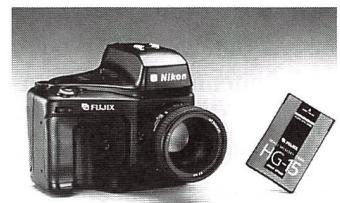
Bei der Spiegelreflex-Digitalkamera Fujix DS-505 / DS-515 sorgt ein Kondensor-Element dafür, dass das gesamte Sucherfeld auf dem CCD-Chip abgebildet wird. Bereits vorhandene Objektive können dadurch wie bisher eingesetzt werden. Die schnell austauschbaren PC-Cards bieten bei einer Speicherkapazität von 15 MB Platz für bis zu 84 Bilder.
