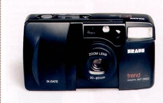
APS muss nicht teuer sein. Bereits für Fr. 348.- gibt es von Braun die neue Trend Zoom AP 360, eine vollautomatische Zweifach-Zoomkamera 30-60 mm mit elektronischem Programmverschluss 1/250 - 1/4 s und Langzeitbelichtung in B-Stellung bis 30 Sek.
