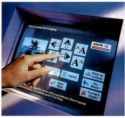
Das neue Agfa Inova Touch benötigt eine Standfläche von nur 113 x 82 cm und besteht aus einem Scanner, einen Pentium 166 MHz PC und einem Thermosublimationsdrucker. Die Bedienung erfolgt einfach über den Touch-Screen Monitor und die selbsterklärende Software. Der Bildschirm zeigt laufend den angewählten Bildeffekt.
