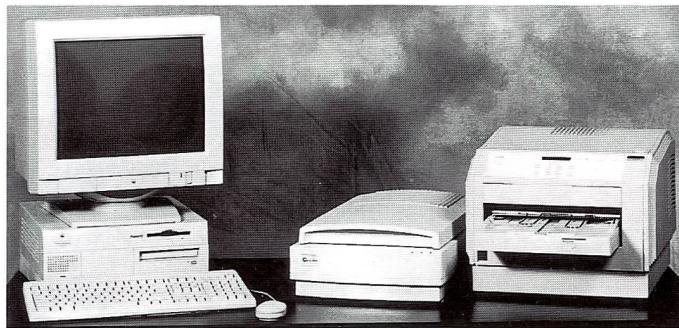
asia»-Systeme Geräte und Software zur Digitalisierung von Bildern, zur Bildmanipulation und -verbesserung sowie zur Ausgabe in Fotoqualität. Zum «Printasia» DS200 gehören ein Flachbett- und ein Kleinbild-Scanner, die eine Digitalisierung sehr verschiedenartiger Bildoriginale und -Formate ermöglichen. Mit dem Flachbett-Scanner können grossformatige Negative und Farbdias bis zur Grösse 21 x 25,4 cm sowie Aufsichtsvorlagen bis DIN A4 gescannt werden; mit dem
