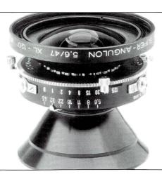
Wir beweisen es: Super-Angulon XL 5,6/47 mm Das Objektiv grenzt an das technisch Machbare: Bildwinkel 120°, Bildkreis Ø 166 mm bei f: 22, Verzeichnung max. 0.5%, Unglaubliche Verstell-möglichkeiten bei den empfohlenen Formaten bis 4x5", Centerfilter zur Behebung des bedingten Randlichtabfalls lieferbar. Neu auch das Super-Angulon XL 5,6/72 m 115° für 9 x12/4,5" bzw. 13 x 18 cm, Bildkreis Ø 226 mm bei f:22
