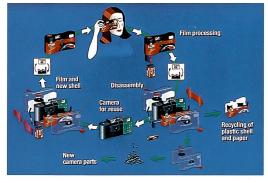
Der Fotohändler entnimmt den Film und lässt ihn entwickeln. Im Werk wird der Kamerakörper mit einer neuen Schale versehen. Sämtliche Teile werden entweder wiederverwendet oder ins Recycling eingeschleust.
