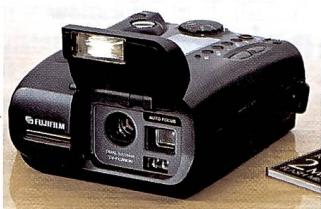
speicherbarer Aufnahmen angezeigt. Die Daten werden ins JPEG-Format komprimiert und können damit problemlos in jedem Bildbearbeitungsprogramm optimiert werden. Die Fujix DS-220 ist die erste Digitalkamera, die mit einem Lithium-Ion-Akkumulator betrieben wird. Es ist ein reichhaltiges Zubehörprogramm verfügbar, darunter ein Makrokonverter für extreme Nahaufnahmen und ein externer LCD-Farbmonitor.
