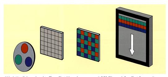
Abb. 1: Von links nach rechts: Three-Shot-Monochromsensor mit RGB-Filterrrad, One-Shot-Sensor mit Mosaikfilter und One-Pass-Zeilensensor mit je einer R-, G- und B-Zeile für Scanner-Kamera
