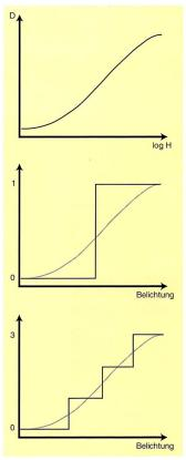
Abb. 4: Von oben nach unten: analoge Aufzeichnung, digitalisierte Aufzeichnung mit 1 Bit und digitalisierte Aufzeichnung mit 2 Bit.
