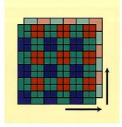
Abb. 2: Auflösungssteigerung durch Microscanning.
