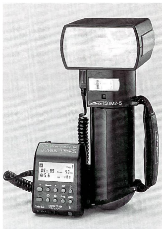
Mit einem Metz mecablight 50 MZ-5 (unten) als «Controller» und mehreren 50 MZ-5 Slave lässt sich jedes Motiv TTL-gesteuert ausleuchten.
