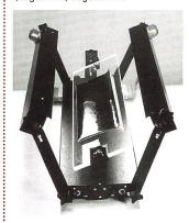
Die Aufnahmefläche von 160 x 550 mm ist horizontal und vertikal schwenk- und arretierbar. Die beiden an der Längsseite angebrachten Lichtquellen können sowohl in der Höhe als auch in sich geschwenkt werden.
