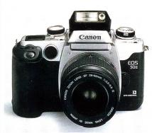
Bei der Canon EOS 50E arbeitet das AF-System augenkontrolliert, d.h. die Scharfstellung stimmt mit der Blickrichtung des Fotografen im Sucher überein. Mittels neun Infrarot-Dioden wird jede Augenbewegung registriert und genau jener Bereich scharf gestellt, der vom Fotografen anvisiert wird.
