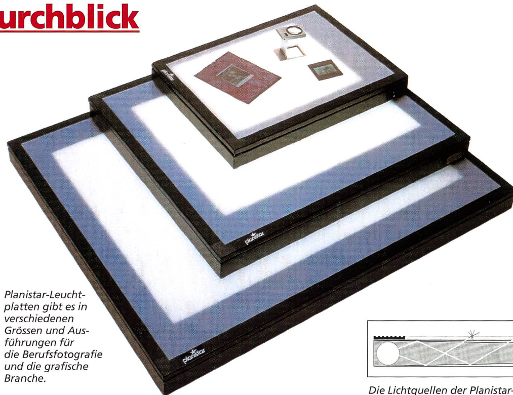
Die Lichtquellen der Planistar-Leuchtpulte befinden sich seitlich an den Geräten. Zusammen mit dem Reflektorsystem wird eine optimale Ausleuchtung erreicht, ohne dass eine Erwärmung der Leuchtplatte auftritt.
