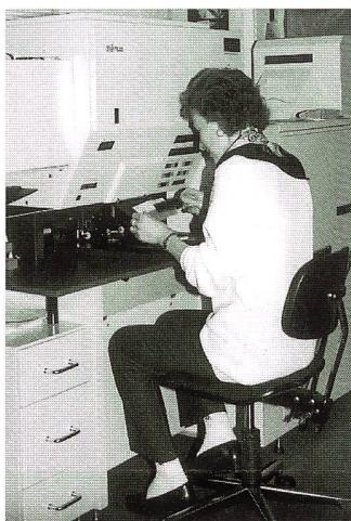
Die neueste Errungenschaft von Foto-Baer ist ein Minilab von Müllersohn. Das Quick-Labor 94 S entwickelt 26 Filme und printet 650 Standardkopien pro Stunde.
