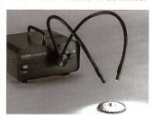
ter ermöglichen eine vielseitige Anpassung der Ausleuchtung an die spezielle Aufgabe. Die Lichtquelle ist eine 150 Watt-Halogenkaltlichtspiegellampe, die von einem geräuscharmen Gebläse gekühlt wird. Sie kann von voller auf reduzierte Beleuchtungsstärke bei gleichbleibender Farbtemperatur von 3200 Kelvin umgeschaltet werden. Ein Lichtleiter mit zwei Armen, jeweils mit 50 cm Länge, einem 4 mm starkem Glasfaserbündel und einer Schwanenhals-Ummantelung ist bereits in der Grundausstattung enthalten.
