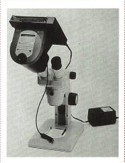
Die Polaroid MicroCam kann anstelle des Okulars problemlos am Binokulartubus des Lichtmikroskops angebracht werden. Sie benötigt keinen zusätzlichen Fotoausgang. Damit ist die neue Kamera die einzige am Markt befindliche Dokumentationsmöglichkeit für Mikroskope ohne Fotoausgang. Die Kamera nimmt automatisch Belichtungen zwischen 1/60 Sekunden und 16 Minuten vor.
