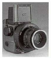
Der neue, variable Zwischenring zum Rolleiflex 6000-System, der mit einer präzise arbeitenden Einstellschnecke für den Auszugsbereich von 22 bis 68 mm ausgestattet ist, ermöglich das Fotografieren im Nahaufnahmebereich bis 1:1 mit Messung durch das Objektiv.
