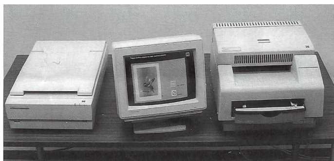
Die Kodak Digital Print Station (DPS) besteht aus drei Komponenten (v.l.n.r.): einem Flachbettscanner, einem 13-Zoll-Touchscreen-Monitor und einem digitalen Thermo-Sublimations-Farbdrucker. Sie ist modular aufgebaut und deshalb sehr platzsparend.
