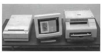
Die Kodak Digital Print Station (DPS) besteht aus drei Komponenten (v.l.n.r.): einem Flachbettscanner, einem 13-Zoll-Touchscreen-Monitor und einem digitalen Thermo-Sublimations-Farbdrucker. Sie ist modular aufgebaut und deshalb sehr platzsparend.
