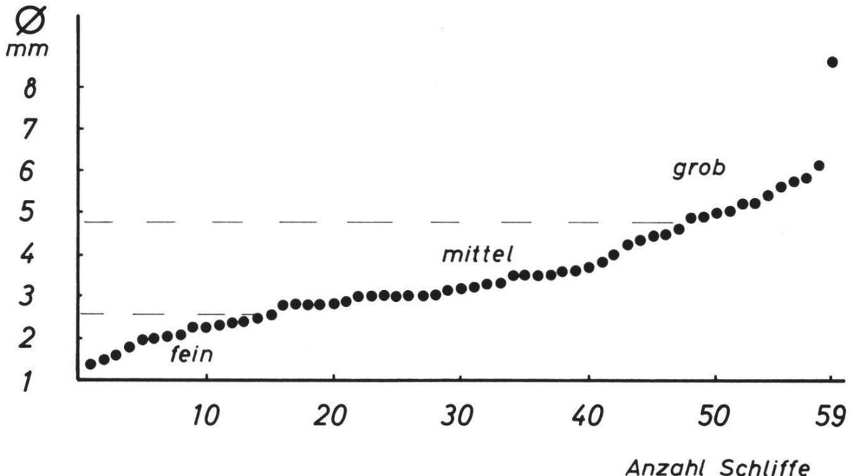
Abb. 10: Verteilung des größten Magerungskorn-Durchmessers auf die 60 untersuchten Scherben. Die Mehrzahl der Scherben gehört zur mittel- bis grobkörnigen Keramik.
