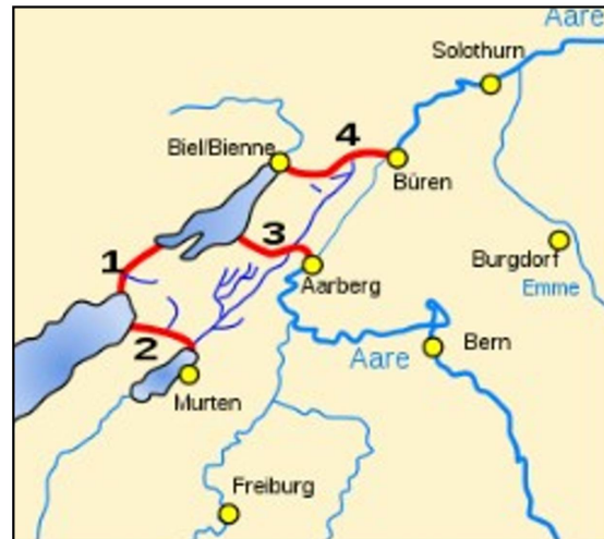
Abbildung 10.4: Die Massnahmen der 1. und der 2. Juragewässerkorrektur von 1868 bis 1891, respektive von 1962 bis 1973: Rot: die vier grosse Kanäle Zihlkanal (1), Broyekanal (2), Hagneckkanal (3) und Nidau-Bühren-Kanal (4); Violett: kleine Entwässerungskanäle.
