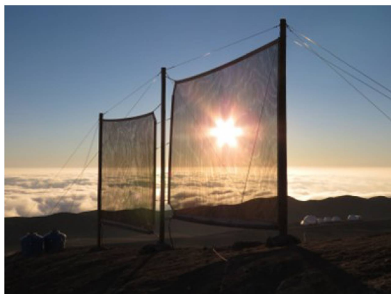
Figure 6.19: Attrapes nuages, ou filets à nuages, du centre de recherche dans le désert d'Atacama (source : https://wiki.lowtechlab.org/wiki/Attrape_Nuages# )
