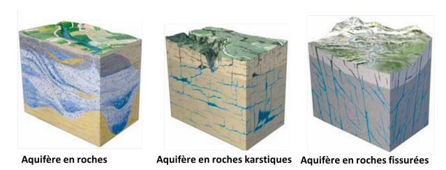
Figure 6.9: Schéma des trois types d'aquifères différents [BRU04].
