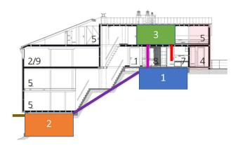
Figure 6.18: Schéma des réservoirs de la cabane (Source de l'image du fond : Guide de construction du CAS).
