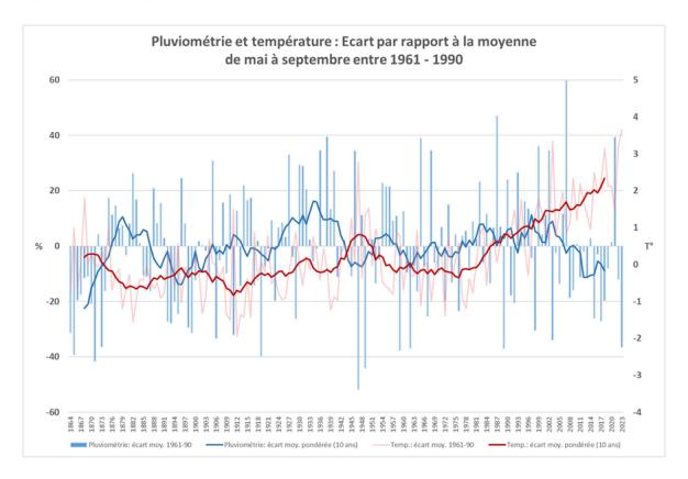
Figure 9.1: Température en hausse et précipitation en baisse en comparaison avec la moyenne de 1961 à 1990 pendant la période de végétation (mai à septembre). Données de la station météorologique de Zollikofen, mise à jour 2023 (MétéoSuisse) Graphique réalisé par F. Schneider.
