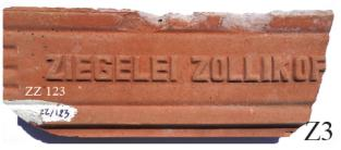
ABBILDUNG 5.23 – Unterseiten der Ziegel aus Zollikofen (Z1, Z2, Z3). Bildbreiten : ZZ 79 8.0 cm, Objektbreite ZZ 106 41.5 cm, Bildbreite ZZ 106 (Oberseite, Zahlen) 9.0 cm, ZZ 123 12.4 cm. Fotos MARINO MAGGETTI.
