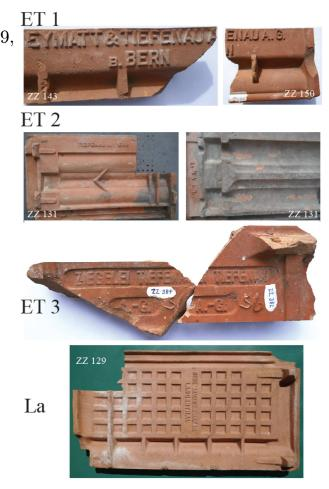
ABBILDUNG 5.19 – Unterseiten der Ziegel aus Eymatt/Tiefenau (Inschriften vom Typ ET1, ET2, ET3) und Langenthal (La). Bildbreiten : ZZ 143 20.8 cm, ZZ 150 12.8 cm, ZZ 131 links 40 cm, ZZ 131 rechts (Oberseite) 28 cm, ZZ 381 & ZZ 382 22.2 cm, ZZ 129 43.5 cm. Fotos MARINO MAGGETTI.
