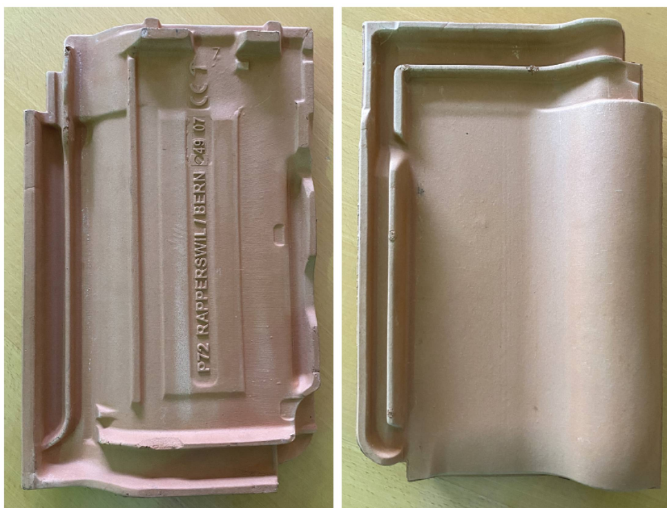
ANHANG 5.5 – Foto der Unter- und Oberseite eines Pfannenziegels, naturrot (ZR), Abkürzung P72 (ZR). Breite 27.0 cm, Deckbreite 20.9 cm, Länge 42.0 cm. © Archiv der Ziegelei LOUIS GASSER AG, Rapperswil.
