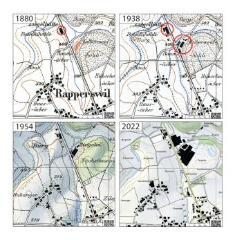
Abbildung 5.7 – Rapperswil. Lage der Ziegelei (roter Kreis) und der Lehmqrube (hellrotes Rechteck. [HUG07c]aufderErstausqabe1880 der soq.SIEGFRIED-Karte 1 : 25'000 Blatt Nr. 139 Gross Affoltern. Auf der Ausgabe 1938 ist das neue Werk, erbaut 1930-31, nahe der Grube gut zu sehen. Die Ausgabe 1954 der LK 1 : 25'000 1146 Lyss zeigt die vergrößerte Grube, während heute das  $\ll Kalberweidh\"{o}zli \gg$ lich verschwunden ist. © swisstopo. GraphischeBearbeitung **MARINO** MAGGETTI.
