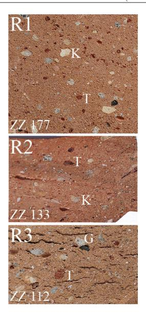
Abbildung 5.27 – Makroskopische Aspekte typischer Dachziegel aus Rapperswil. Erläuterung im Text. Gesägte Probenfläche. Bildbreite je 1.9 cm. Fotos MARINO MAGGETTI.
