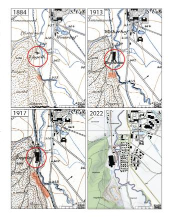
ABBILDUNG 5.10 – Roggwil. Lage der Ziegelei (roter Kreis) und der Lehmgrube (hellrotes Rechteck, [HUG07d]) auf der Erstausgabe 1884 der sog. SIEGFRIED-Karte 1: 25'000 Blatt Nr. 165 Pfaffnau. Die Ausgaben von 1913 und 1917 zeigen die weitere Entwicklung der Fabrik und den topographierten Gruben (hellrote Rechtecke). © swisstopo. Graphische Bearbeitung MARINO MAGGETTI.
