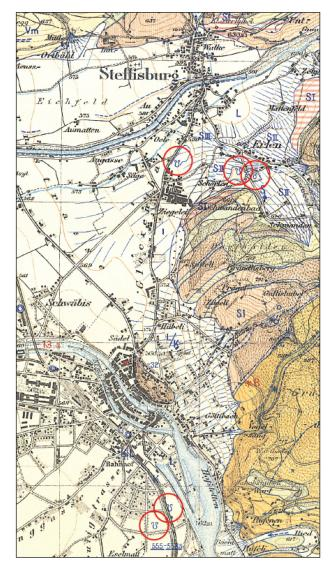
ABBILDUNG 5.17 – Ausschnitt der geologischen Spezialkarte Karte 1:25'000 von BECK/GERBER ([BEC25]) mit den damals bekannten Abbaustellen (blaues Spezialzeichen) der Ziegeleirohstoffe im Seefeldquartier und in der Umgebung der Ziegelei Glockenthal. Graphische Bearbeitung (rote Kreise um die Spezialzeichen) durch MARINO MAGGETTI.
