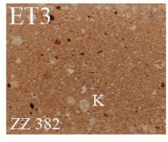
ABBILDUNG 5.24 - MakroskopischeAspekte typischer Dachziegel aus Eymatt/Tiefenau. Erläuterung im Text. Gesägte Probenfläche. G =Granitkorn, K = ehemaliges Karbonatkorn, T = eisenreiche Tonknolle. Bildbreite je  $1.9 \, \mathrm{cm}$ . Fotos MARINO MAGGETTI.
