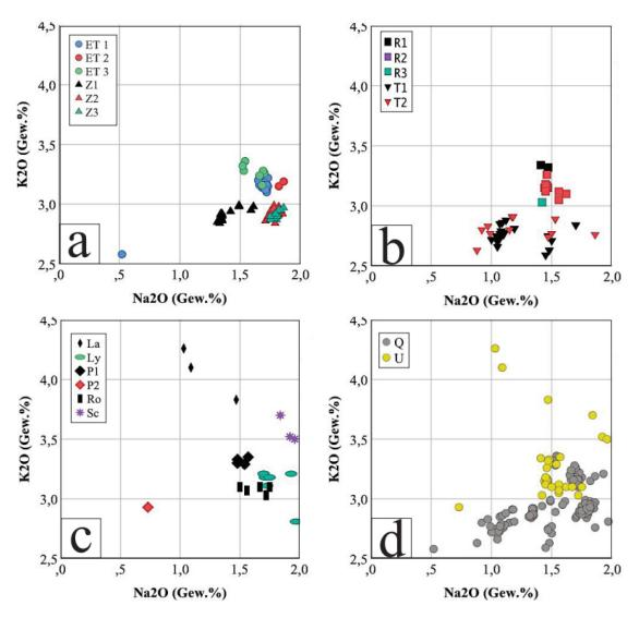
Abbildung 5.32 – Lage der 148 analysierten Dachziegel im binären Korrelationsdiagramm  $K_2O$ -Na<sub>2</sub>O. Signaturen s. Abb. 5.30. Zeichnung MARINO MAGGETTI.
