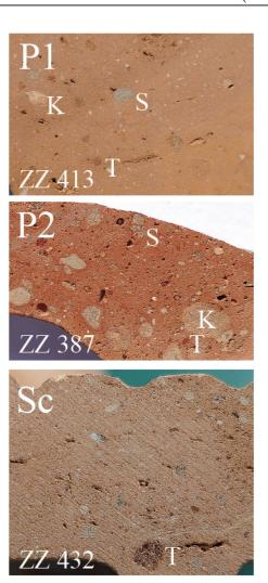
Abbildung 5.26 – Makroskopische Aspekte typischer Dachziegel aus Pieterlen und Schüpfen. Erläuterung im Text. Gesägte Probenfläche. Bildbreite je 1.9 cm. Fotos MARINO MAGGETTI.
