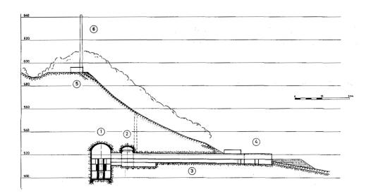
ABBILDUNG 4.1 – Schnittbild des Standortes der CNEL in Lucens/VD. Der Fluss Broye und die Straße Lucens-Moudon-Lausanne befindet sich rechts außerhalb des Bildes. Quelle [PER82]. Legende: (1) Reaktorkaverne, (2) Maschinenhalle, (3) Zugangsstollen, (4) Betriebsgebäude, (5) Abluftanlage, (6) Abluftkamin.
