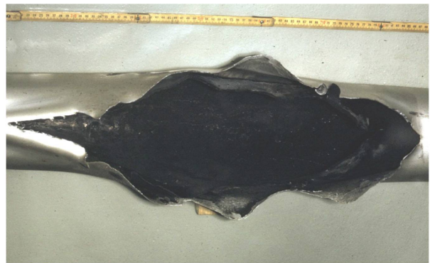
ANHANG 4.4 – Gebrochenes Brennelement des Reaktors der CNEA. (Bild : ENSI-Webseite)
