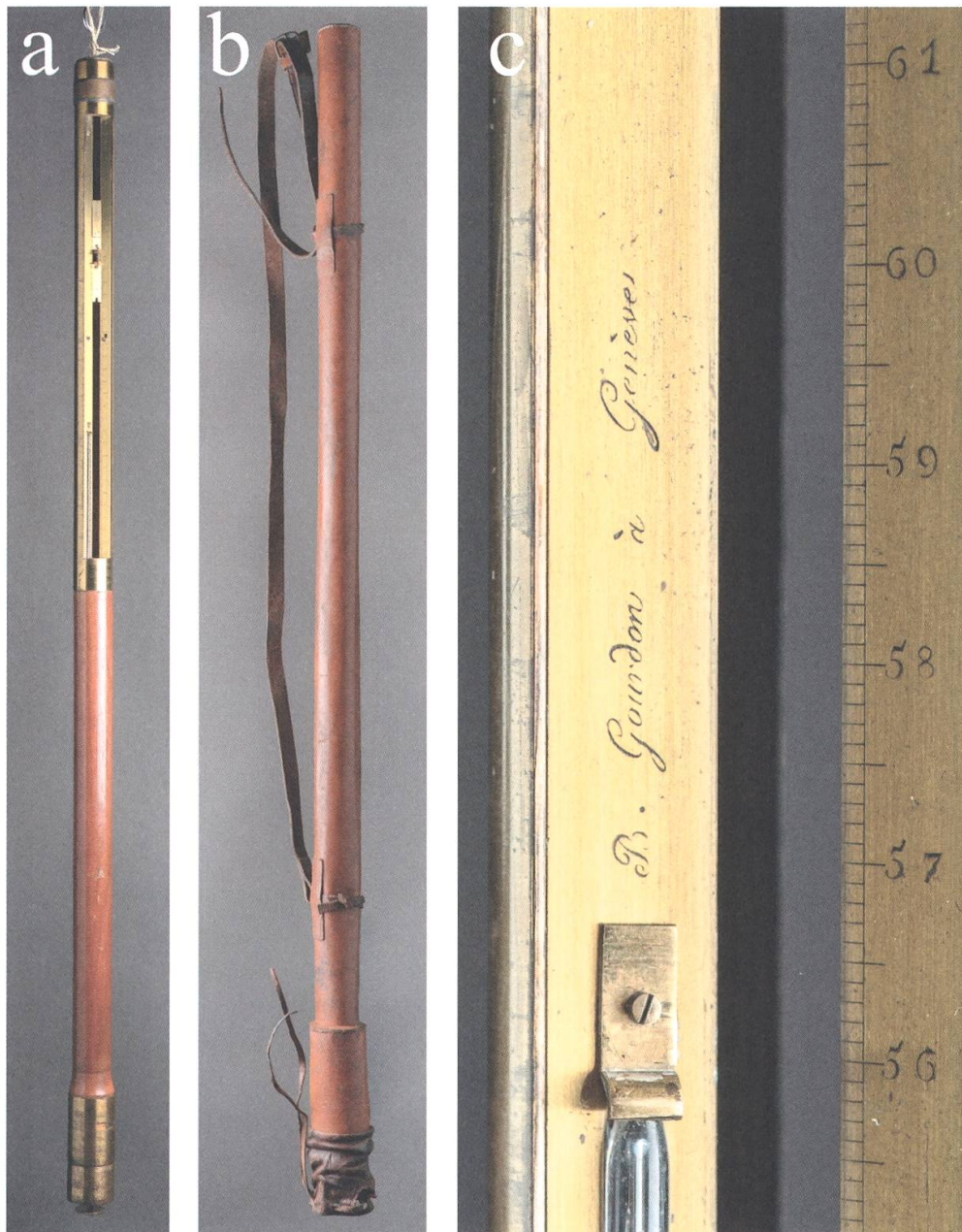
Abb. 13: Transportables Feld-Barometer aus der Werkstatt der Gebrüder GOURDON in Genf. (a) Barometer, Höhe 94 cm, ohne Glastubus. MHS 1059; (b) Transportetui, Höhe 96 cm. MHS 1060; (c) Signatur B[arthélémy] GOURDON à Genève und Graduierung. MHS 1059. Fotos Musée d'histoire des Sciences, Genève.
