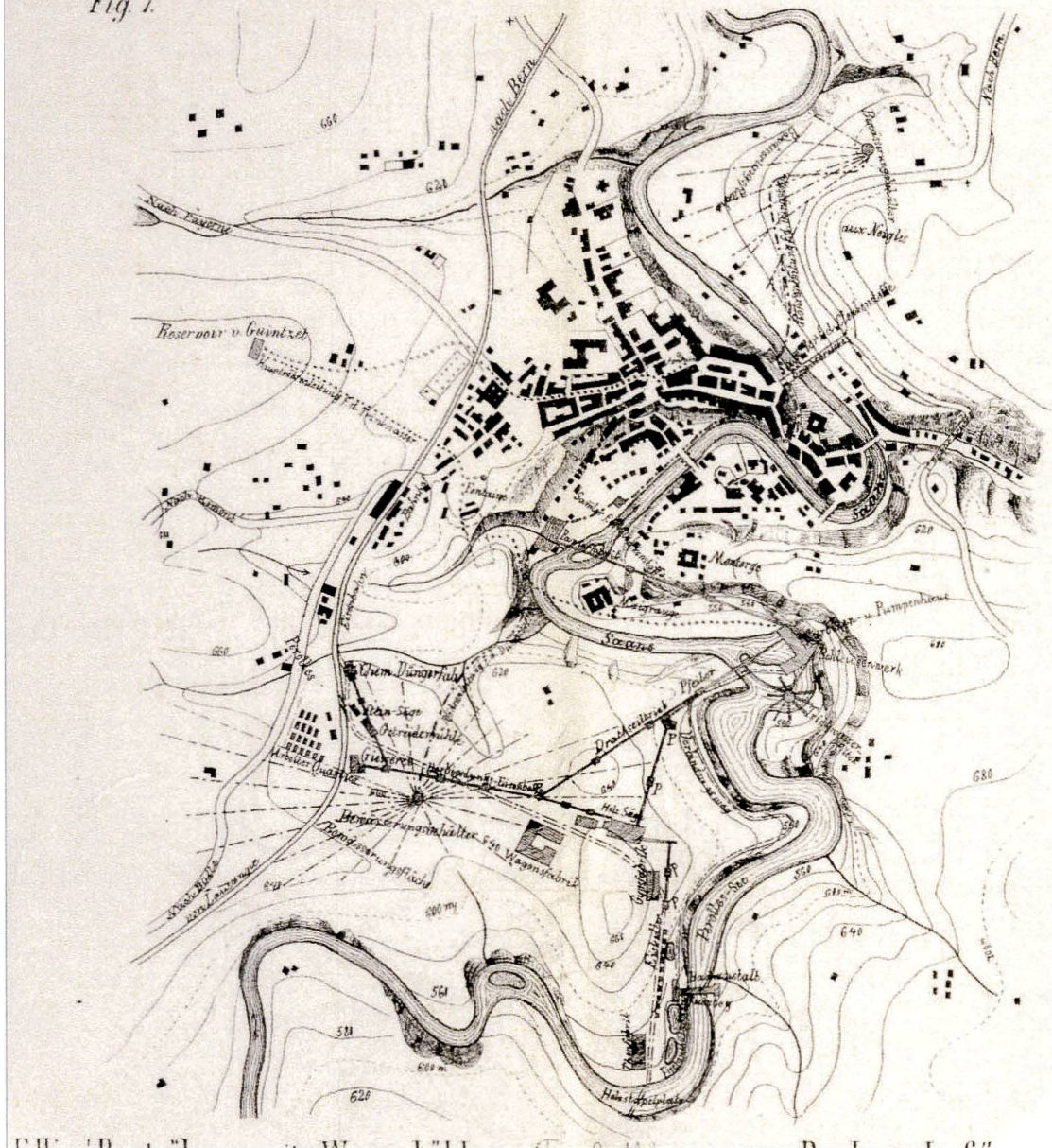
Abb. 1b: Karte Freiburgs mit den RITTER'schen Projekten: Nebst Stauwehr, Kraftwerk und Filteranlagen sind auch die Kraftübertragungsanlagen mit Drahtseilen, die Masten für die Trägerrollen, die verschiedenen Industrieanlagen, die Wasserleitungen von der Stauwehr zum Guintzet und von dort zu den Brunnen in der Stadt sowie die Bewässerungsanlagen auf dem Plateau Pérolles und in den Neigles eingezeichnet. Der Vergleich zu Abb. 1a lässt vermuten, dass nicht alle Projekte RITTERS verwirklicht wurden. (Quelle: Artikel von GANGOLF DELABAR im Polytechnische Journal Band 207, Nr. XXV, 1873, pp. 89-108)
