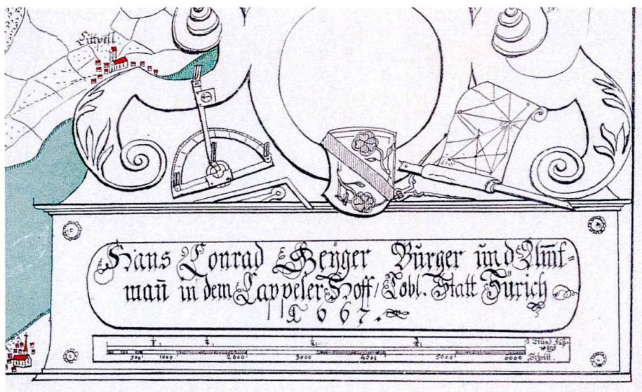
Abb. 7: Ausschnitt der Titeltartusche der Karte des Kantons Zürich 1657 von HANS CONRAD GYGER (GYGER & ZELLER-WERDMÜLLER 1891, ZÖLLY 1941). Links vom Wappenschild ist ein Halbkreis mit Kompass und Visiereinrichtung zu sehen. Foto M. MAGGETTI.
