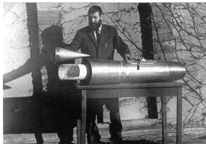
Abb. 6: Die Pioniere OTTO HUBER (oben), JOSEPH HALTER (mitte) und PAUL WINIGER (unten) – Letzterer mit dem Sammelgerät der Schweizer Luftwaffe für Luftproben aus der oberen Troposphäre bzw. unteren Stratosphäre. Zwei solcher Geräte wurden in den 60er-Jahren in Zusammenarbeit mit den damaligen Eidg. Flugzeugwerken Emmen entwickelt und sind noch heute (nach Anpassung an neue Flugzeuge) im Einsatz.
