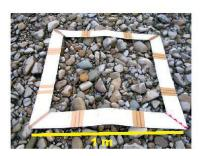
Fig. 14: Masque utilisée pour la prospection et échantillonnage
