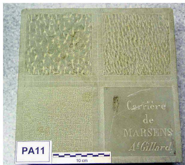
Abb. 7: Probe PA 11 aus dem Steinbruch von Marsens (Besitzer A. GILLARD) mit drei verschiedenen Oberflächen-Bearbeitungsvarianten. Sammlung Technische Geologie des Naturhistorischen Museums Freiburg, Inv. Nr. 20589. Photo MARINO MAGGETTI.
