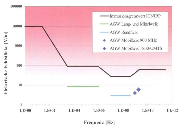
Figur 1: Grenzwerte für das elektrische Feld in Abhängigkeit der Frequenz des EMF nach <sup>20</sup>.
