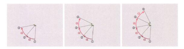
FIGURE 6 – On place les billes les unes après les autres à un angle  $\alpha$  de la précédente.
