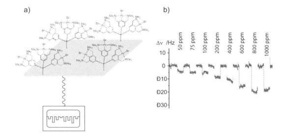
**Abb. 4:** Sensor für die Bestimmung von atmosphärischem Schwefeldioxid in der Gasphase: a) schematischer Aufbau des Sensors bestehend aus einer mit Platin-Komplexen beschichteter Quarzplatte, deren Eigenschwingung aufgezeichnet werden kann; b) Typische Messresultate mit einer beschichteten Quarzplatte und verschiedenen SO<sub>2</sub>-Konzentrationen (Messreihe aufgenommen bei 50 °C). Der Sensor wurde zwischen zwei Messungen jeweils kurz mit Stickstoff (N<sub>2</sub>) gespült.
