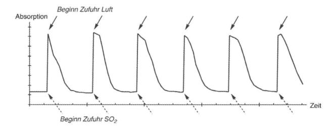
**Abb. 3:** Messung der Absorption bei  $\lambda_{max} = 420$  nm in Funktion der Schwefeldioxid-Konzentration der Umgebung. Auch nach mehreren Messzyklen bleibt sowohl das Maximum als auch das Minimum unverändert, was auf die vollständige Reversibilität der Rezeptor-Substrat-Wechselwirkung hindeutet.
