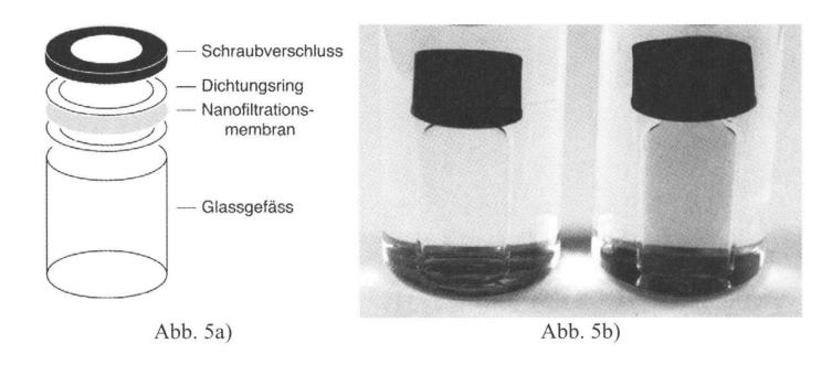
**Abb. 5:** Prototyp eines Sensors zur Detektion von Schwefeldioxid in Probe-Lösungen: a) schematischer Aufbau der Messzelle; b) in SO<sub>2</sub>-freier Lösung bleibt die Messzelle farblos (links), in SO<sub>2</sub>-haltiger Lösung verfärbt sie sich rasch orange (rechts).
