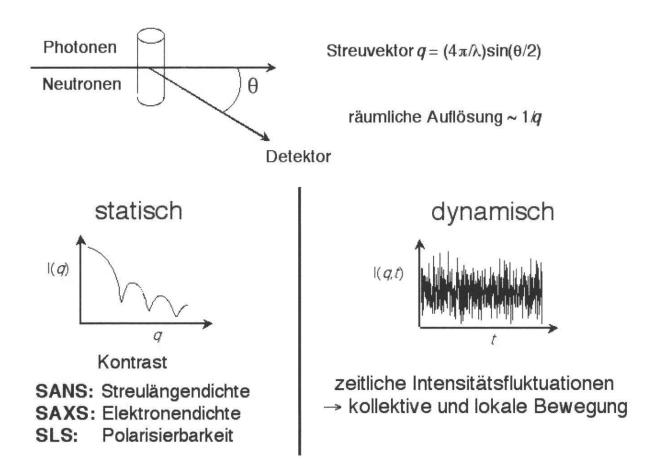
**Figur 4:** Schematische Darstellung eines Streuexperimentes, in dem Licht, Röntgenstrahlung oder Neutronen an einer kolloidalen Suspension gestreut und die resultierende Streuintensität entweder als Funktion des Streuvektors q zeitlich gemittelt gemessen oder ihre durch die Systemdynamik hervorgerufenen zeitlichen Fluktuationen analysiert werden.
