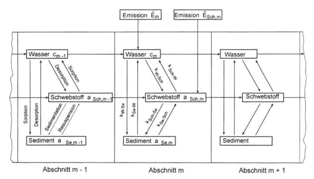
Abb. 24: Kompartimentmodell zur Berechnung der Aktivitätskonzentration in Wasser und spez. Aktivität in Schwebstoff und Sediment in Fliessgewässern /Hö 93/
