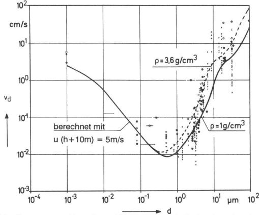
Abb. 12: Gemessene und berechnete Ablagerungsgeschwindigkeit an Gras in Abhängigkeit vom Partikeldurchmesser d und der Dichte  $\rho$  /Ho 84<sub>2</sub>//Ho 88/
