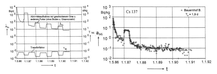
Abb. 19: Gemessene und mit einem Einkompartimentmodell berechnete spez. Cs 137-Aktivität in Kuhmilch nach dem Unfall in Tschernobyl in Aachen /Bo 98<sub>1</sub>/
