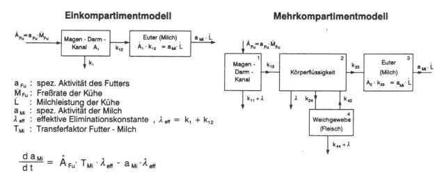
Abb. 17: Kompartimentmodelle zur Berechnung der spez. Aktivität in Kuhmilch und Rindfleisch /Bo 98<sub>1</sub>/
