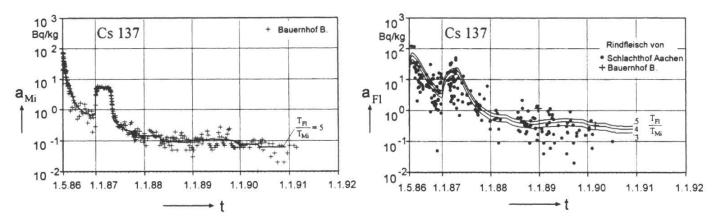
Abb. 20: Gemessene und mit einem Mehrkompartimentmodell berechnete spez. Cs 137-Aktivität in Kuhmilch und Rindfleisch nach dem Unfall in Tschernobyl in Aachen /Bo 98<sub>1</sub>/
