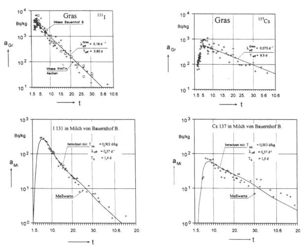
Abb. 18: Gemessene und mit einem Einkompartimentmodell berechnete spez. I 131- und Cs 137-Aktivität in der Kuhmilch nach dem Unfall in Tschernobyl in Aachen /Bo 98<sub>1</sub>/
