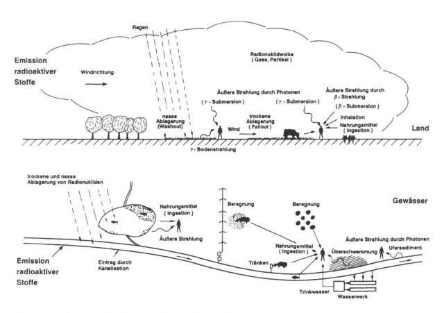
Abb. 1: Radionuklidtransport und Expositionspfade
