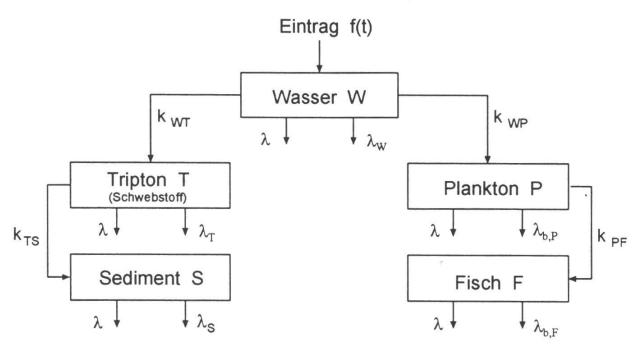
Abb. 27: Kompartimentmodell zur Berechnung der spezifischen Aktivität in Seen /Hü 91/
