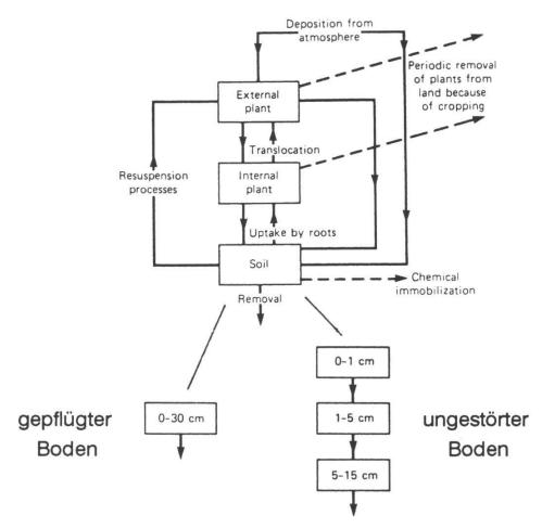
Abb. 7: Kompartimentmodell Boden- Pflanzen der NRPB /Cl 79/ / Si 81/
