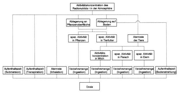
Abb. 5: Dosimetrisches Modell für den Luftpfad im Computerprogramm HERMES /Fl 71/ /So 73/
