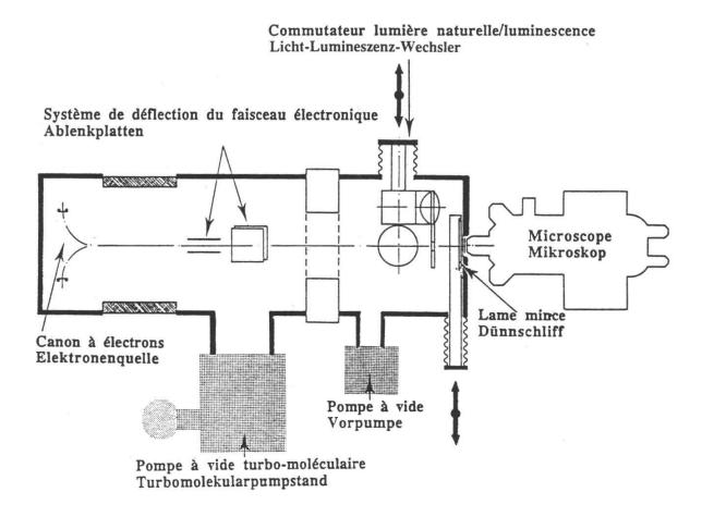
Fig. 1: Schéma de principe du microscope de cathodoluminescence
