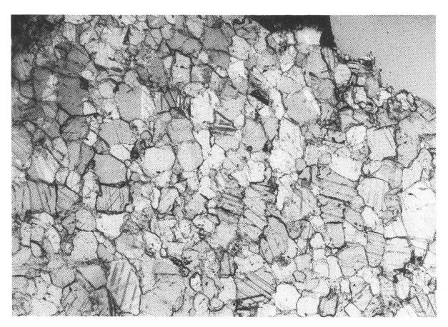
Fig. 3: Marbre de Carrare (microphotographie en lumière transmise).
