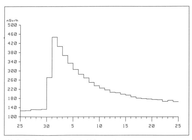
Abb. 5: Registrierung der Ortsdosisleistung mit der NADAM-Sonde «Zürich-SMA» vom 25.4.–25.5.1986 angegeben in nSv/h (=10<sup>-9</sup> Sievert pro Stunde) (aus KUeR-Bericht 1985/86).
