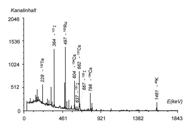
Abb. 3: Gamma-Spektrum einer Salatprobe aus dem Tessin vom 12. Mai 1986, gemessen mit Ge-Detektor im AC-Labor Spiez. Deutlich sind u.a. die Nuklide Ruthenium-103, Jod-131, Tellur-132, Caesium-134 und Caesium-137 und das natürliche Kalium-40 erkennbar.
